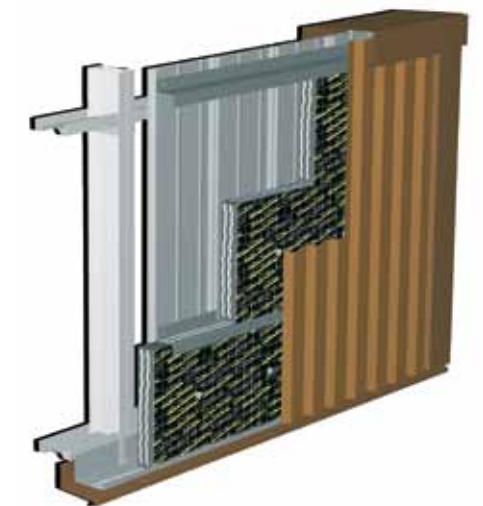
Tragende Unterkonstruktion und Wandaufbau Hairaqua
